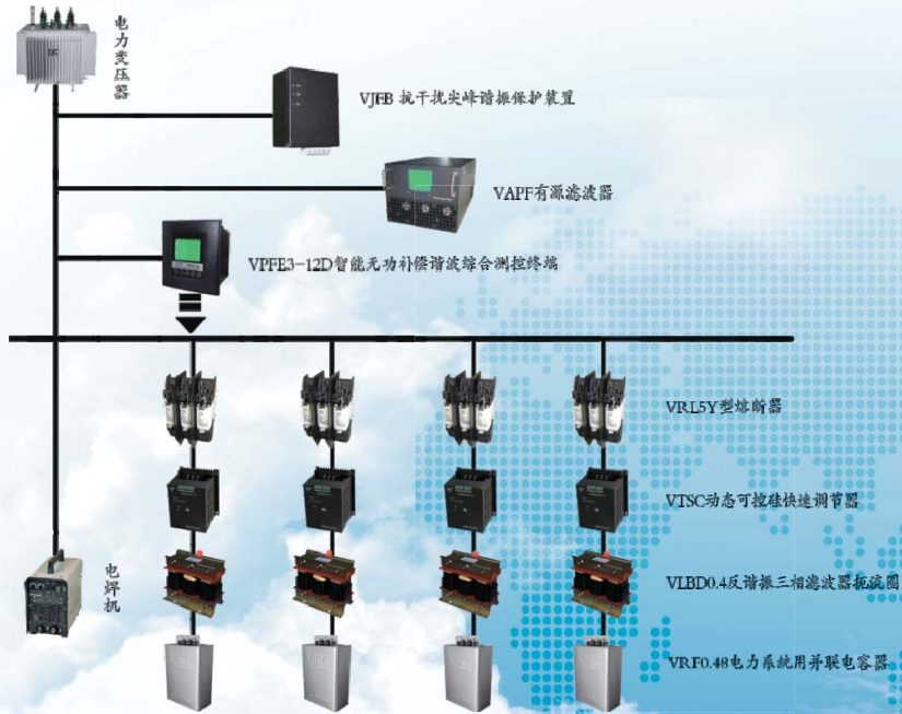
动态快速及谐波滤波补偿方案应用图 (经天津电传所权威测试可控硅动态响应时间≤5-10ms,可能是目前最快的动态装置)
